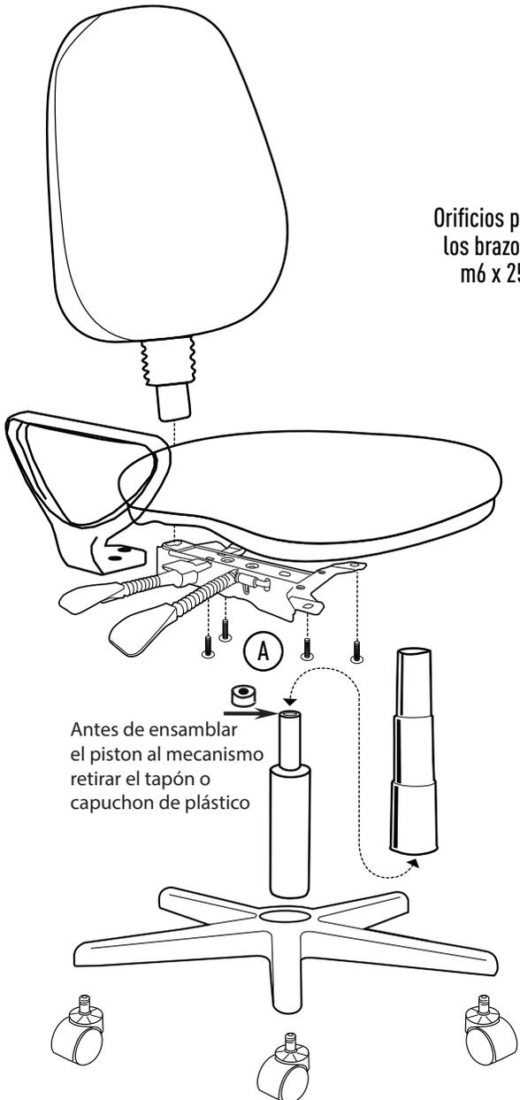
Antes de ensamblar el pistón al mecanismo retirar el tapón o capuchon de plástico
